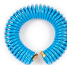
AP-801215 Шланг витой ПУ • Внутренний Ø 8 мм • Внешний Ø 12 мм • Длина шланга 15 м • Тип резьбы: внешняя • Ø резьбы 1/4"
