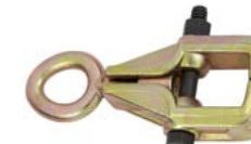
ATG-6203 Кузовной зажим с большим зевом №2 •Одно направление •Cr-Mo •Максимальная нагрузка: 3 т •Резьба винта: M14x 110 мм
