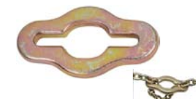
ATG-6189 Кольцо для укорачивания кузовной цепи •Подходит для укорачивания и соединения кузовных цепей •Cr-Mo •Для цепей с сечением: 5/16" и 3/8" •Грузоподъемность: 6 т
