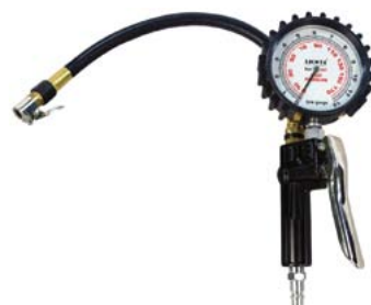
PAP-D057-4 Пневматическая подкачка шин с манометром • Диапазон показаний 0 - 12 bar • Цена деления 0,1 bar • 3-х функциональная • Крупная легкочитаемая шкала в BAR и PSI • Поворотный манометр на шарнирном соединении • Шланг 1 м x 1/4"
