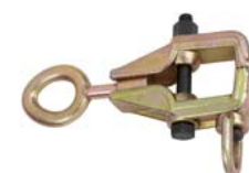
ATG-6204 Кузовной зажим с большим зевом •Два направления •Cr-Mo •Максимальная нагрузка: •Направление прямо: 3 т •Направление под углом: 2 т •Резьба винта: M14 x 110 мм
