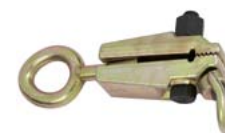
ATG-6201 Кузовной зажим с узким захватом •Два направления •Cr-Mo •Максимальная нагрузка: •Направление прямо: 5 т •Направление под углом: 2 т •Резьба винта: M16 x 70 мм
