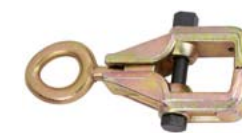
ATG-6202 Кузовной зажим с большим зевом №1 •Одно направление •Cr-Mo •Максимальная нагрузка: 3 т •Резьба винта: M14x 120 мм
