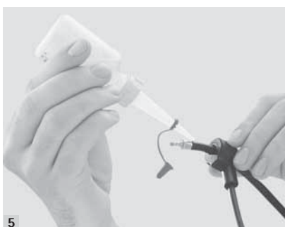
5 Nun die Zündleitung mit Montageöl benetzen. Now lubricate the ignition cable with installation oil.
