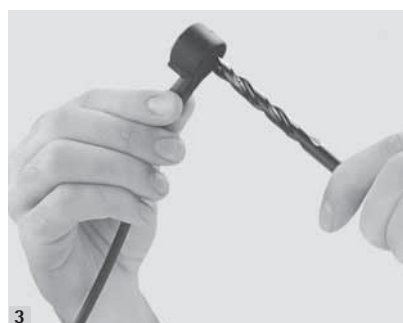
3 Den Impulsgeber auf 8 mm aufbohren (Bohrer von Hand drehen). Drill 8 mm hole on the pulse timer (turn drill by hand).
