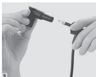
6 Zuletzt den Zündverteilerstecker des CopperCable aufschrauben. Finally, screw on the ignition distributor connector of the CopperCable.
