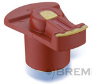
7035 Zündsystem / system Bosch Polyester/Polyester 1000 Ohm entstört/suppressed Verwendung für: / applicable for: PORSCHÉ
