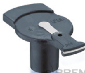
7505 Zündsystem / system Hitachi Polypropylen/Polypropylen nicht entstört/not suppressed Verwendung für: / applicable for: HONDA ROVER
