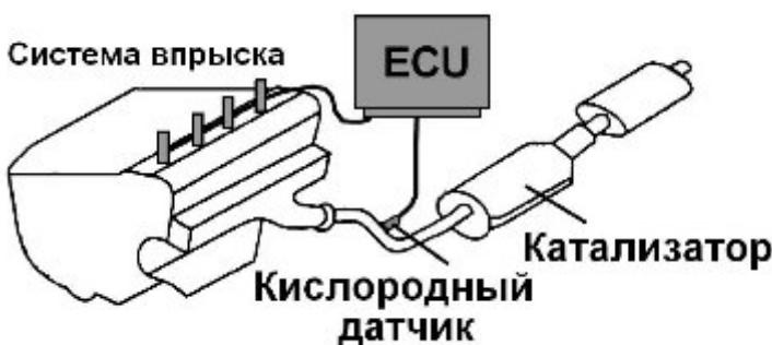
В процессе своей работы, ECU (электронный блок управления) автомобиля использует информацию, передаваемую ему кислородным датчиком. Принимая сигналы датчика, ECU постоянно увеличивает или уменьшает время работы системы впрыска, в зависимости от полученной информации о обогащенности подаваемой в двигатель топливной смеси.
